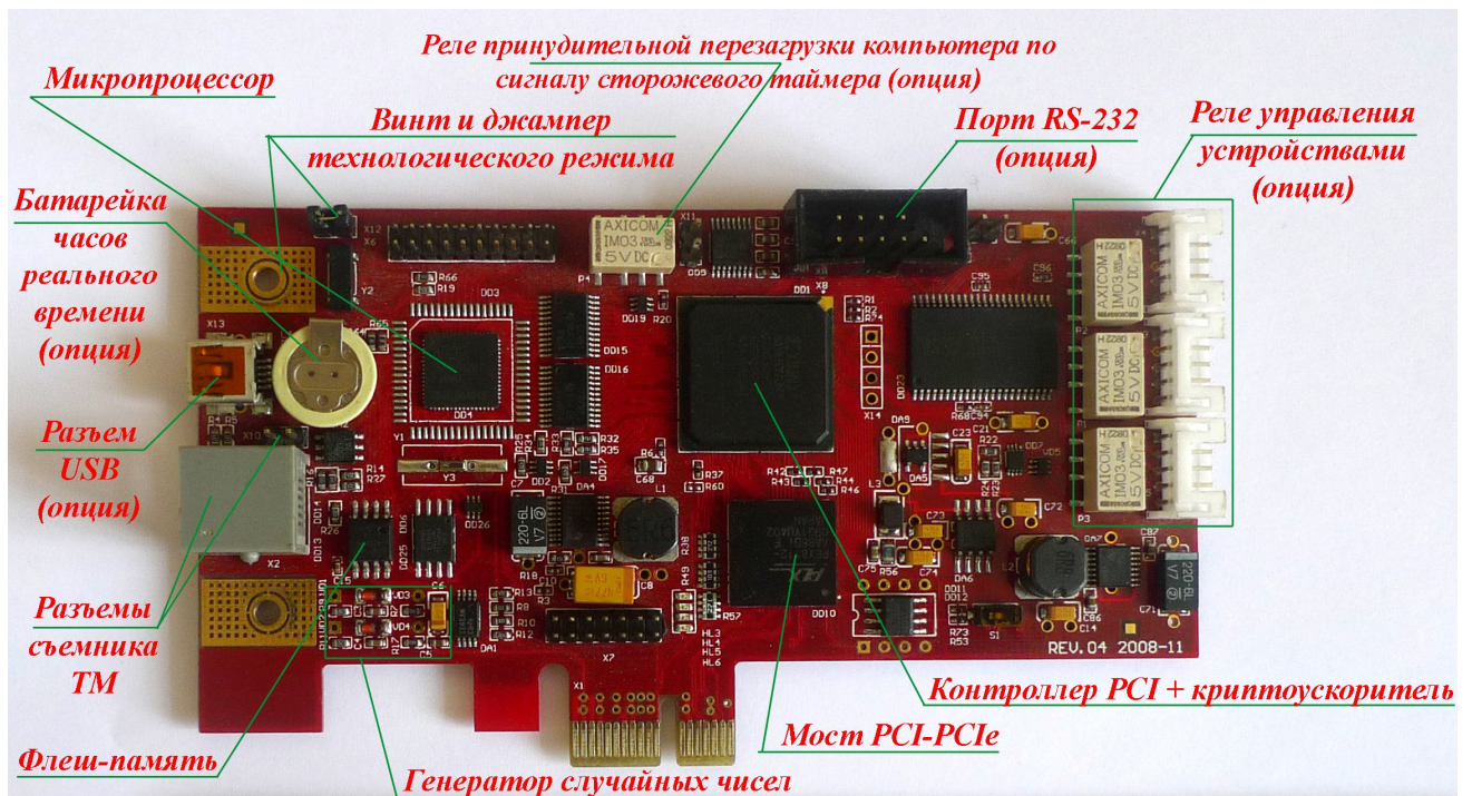
Рисунок 3 - Плата контроллера «Аккорд-5.5е»
